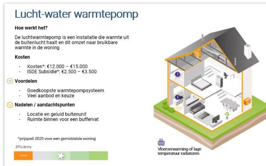
Figuur 7: Overzicht Lucht-water warmtepomp
